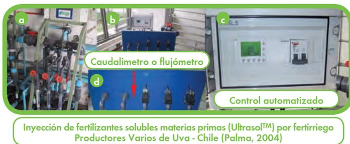
**Figura 115.** Inyección de fertilizantes materias primas por fertirriego en sistemas sofisticados en Argentina y Chile. Ver detalles de fotografías a,b,c y d. (Palma, 2004; Oyarzun-Azud Chile, 2004).
