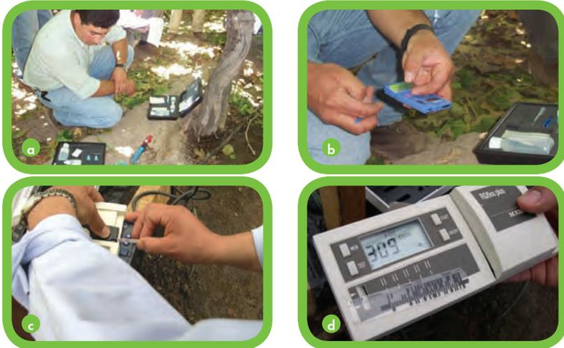
**Figura 28.** Monitoreo nutricional en extractómetro a través de equipo de electrodos (marca Hobira (a y b), Cardy) y de bulbo de riego a través de extracto de saturación medible en equipo Reflectoquant RQ-Flex Plus Merck (c y d) (Palma, 2003. Visita a terreno, Chile y Colombia).
