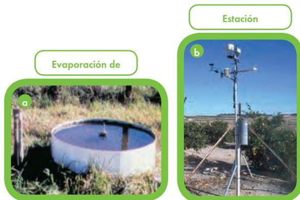
**Figura 22.** Estación meteorológica (b) y bandeja de evaporación (a) (Selles, 2003).
